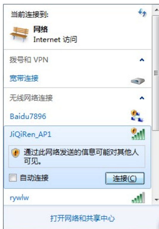
图 2-8-5 电脑连接 RobotTTP 本体 WIFI
